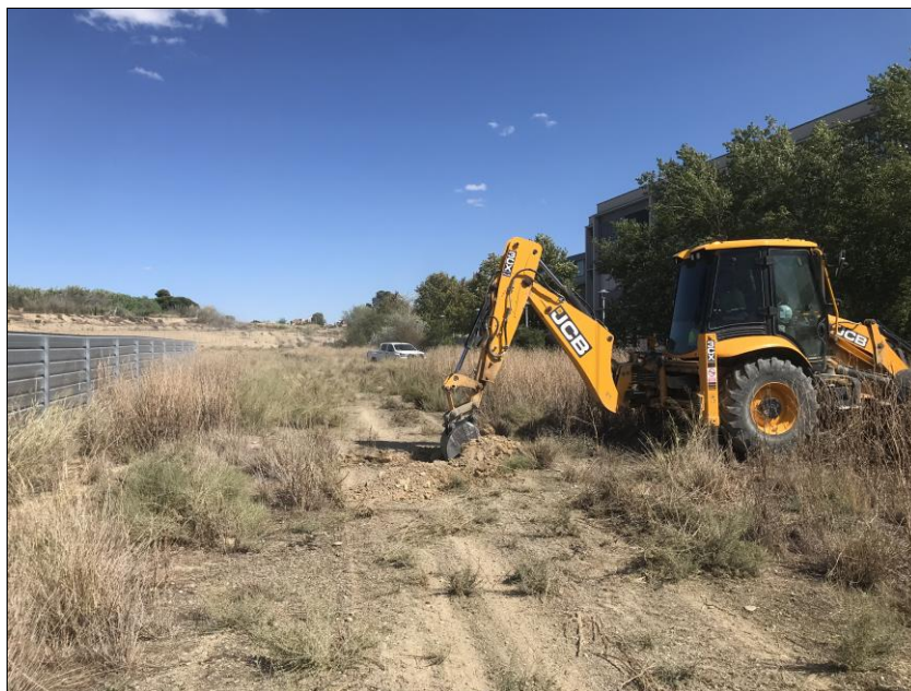
Imagen 7. Detalle de la maquinaria utilizada en la realización de las catas. Mixta JCB 3CX
